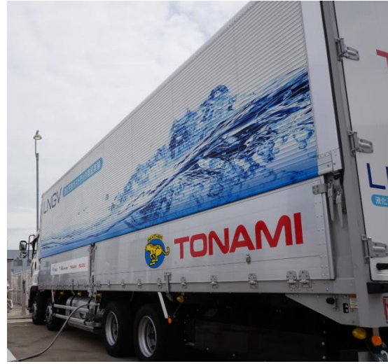
LNG 充填中の様子
